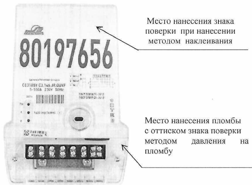
Рисунок 2.3 - Схема (рисунок) с указанием места для нанесения знака поверки на счетчик CE318BY в типе корпуса С3
