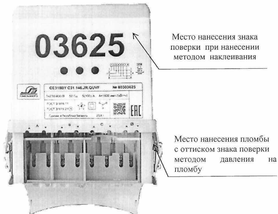
Рисунок 2.4 - Схема (рисунок) с указанием места для нанесения знака поверки на счетчик CE318BY в типе корпуса С31
