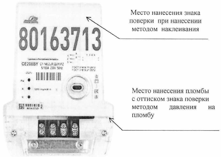
Рисунок 2.1 - Схема (рисунок) с указанием места для нанесения знака поверки на счетчик CE208BY в типе корпуса S51, S53
