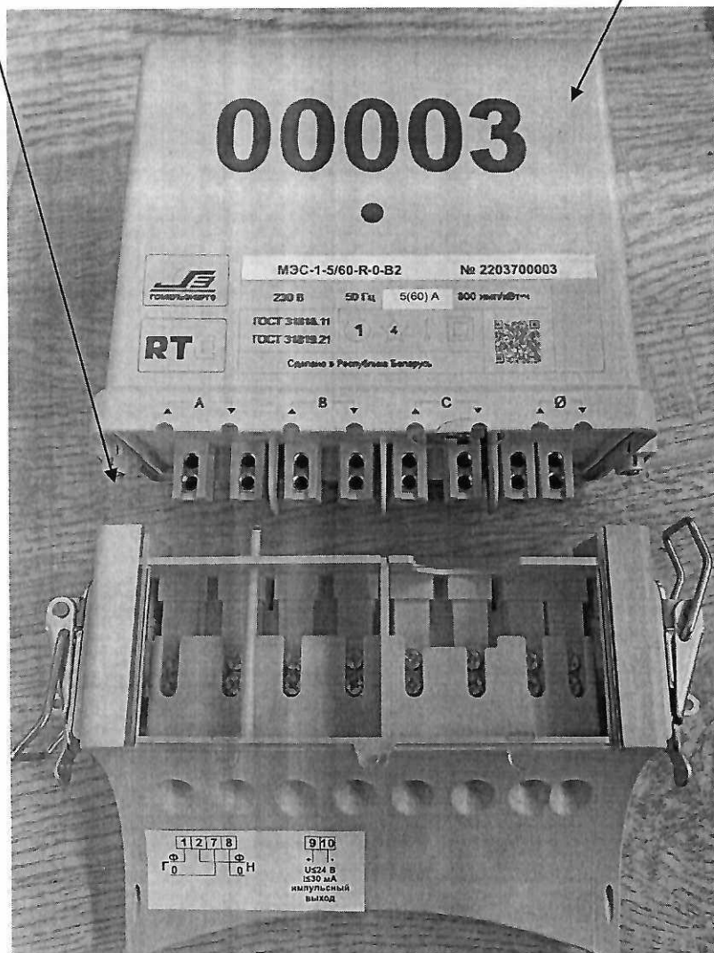
Рисунок А.2 – Внешний вид, место установки пломбы от несанкционированного доступа и нанесения знака поверки для счётчиков МЭС-1 в исполнении корпуса сплит, сплит с розеткой и индикатором считывания информации
