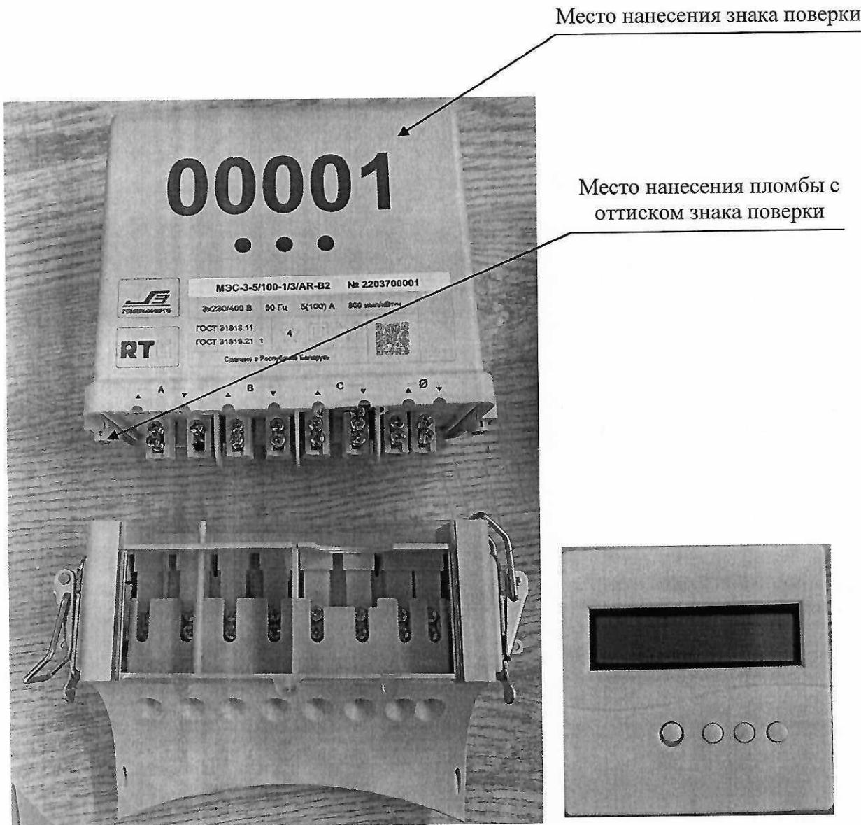
Рисунок А.2 – Внешний вид, место установки пломбы от несанкционированного доступа и нанесения знака поверки для счётчиков МЭС-3 в исполнении корпуса сплит, сплит с розеткой и индикатором считывания информации
